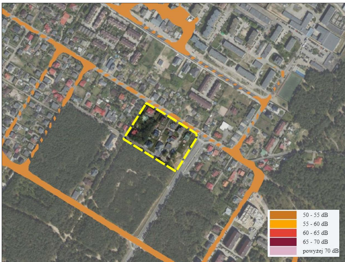
Rysunek 10. Mapa akustyczna Miasta Włocławek - poziomy hałas drogowy w porze nocnej (obszar objęty opracowaniem zaznaczono żółtą linią przerywaną; źródło: geoportal.wloclawek.eu)
