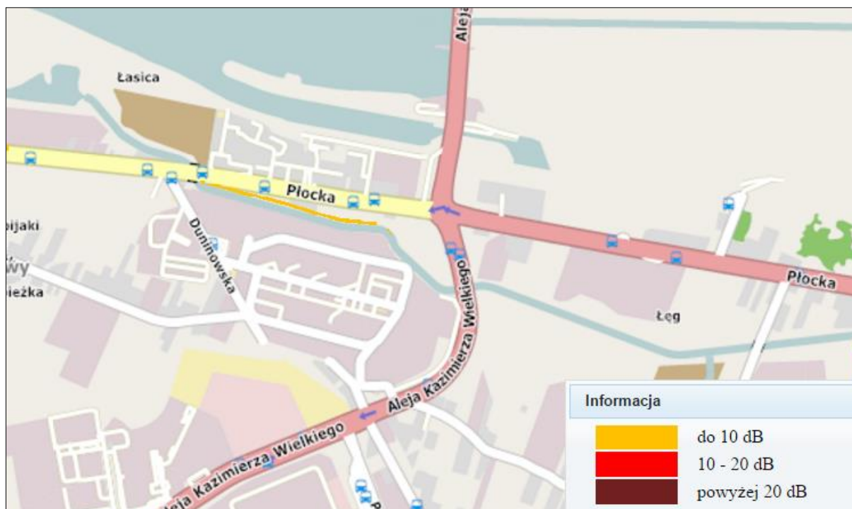
Rysunek 15. Mapa akustyczna Miasta Włocławek - wielkości przekroczeń hałasu przemysłowego w ciągu dnia i nocy (źródło: geoportal.wloclawek.eu )
