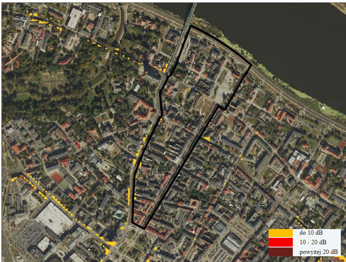
Rysunek 12. Mapa akustyczna Miasta Włocławek - wielkości przekroczeń hałasu drogowego w porze dziennej, wieczornej i nocnej (obszar objęty opracowaniem zaznaczono czarną linią; źródło: geoportal.wloclawek.eu)
