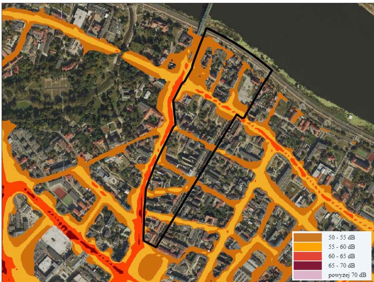
Rysunek 11. Mapa akustyczna Miasta Włocławek - poziomy hałasu drogowego w porze nocnej (obszar objęty opracowaniem zaznaczono czarną linią; źródło: geoportal.wloclawek.eu)
